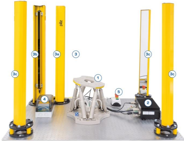
Fig. 5 Der Hexapod ist an vier Seiten vom Lichtvorhang umgeben. 1: Hexapod. 2: Hexapod-Controller C-887. 3: Sicherheitslichtvorhang. 3a: Sender. 3b: Empfänger. 3c: Spiegel. 4: Schaltgerät, Relais, Spannungsversorgung. 5: Not-Halt-Schalter, Reset-Taster
